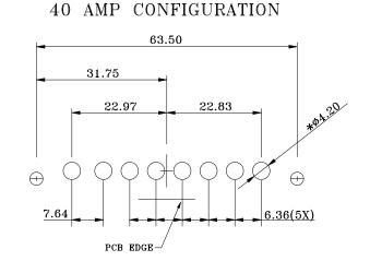
RECOMMENDED PCB LAYOUT \*TYPICAL // HOLE SIZE MAY NOT BE SUITABLE FOR YOUR SPECIFIC APPLICATION
