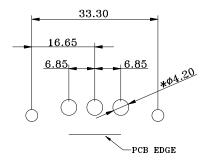
RECOMMENDED PCB LAYOUT \*TYPICAL // HOLE SIZE MAY NOT BE SUITABLE FOR YOUR SPECIFIC APPLICATION
