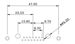
RECOMMENDED PCB LAYOUT \*TYPICAL // HOLE SIZE MAY NOT BE SUITABLE FOR YOUR SPECIFIC APPLICATION
